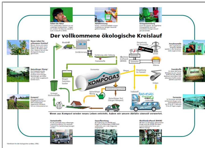
Figur II.1a-5: Verfahrensbild zur Bioabfallvergärung nach dem KOMPOGAS-Verfahren
